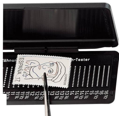
Figuur 4. Tanding gemeten met Phila Combibox. De tanding is 13%.
